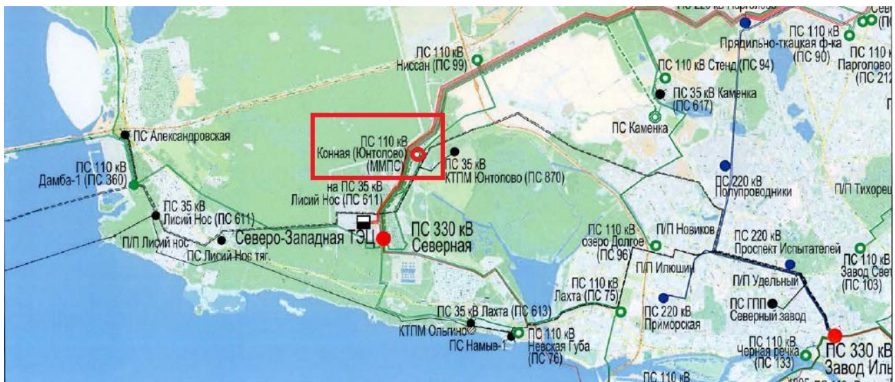
Рисунок 1 – Схема сети 110 кВ и выше района
